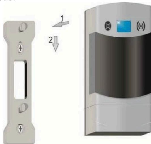
Рисунок 3 – Установка извещателя
