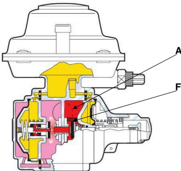
Направляется через седло клапана **Va** в камеру **M**, где имеет место первый перепад давления с редуцированием до надлежущего давления посредством регулирующей группы
