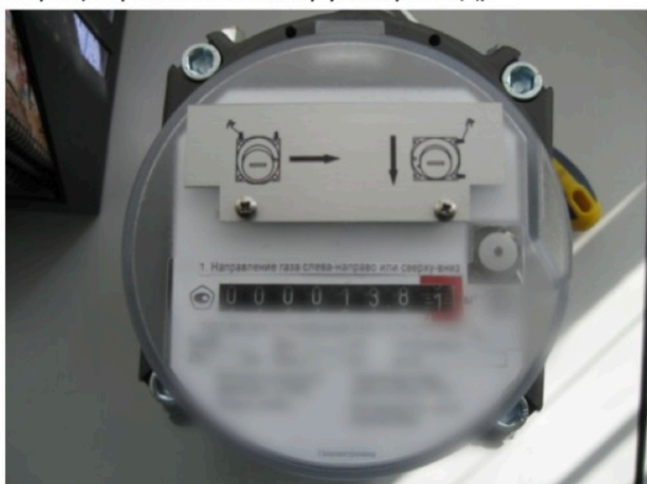
Рисунок 1 — Счетная голова с двумя счетными барабанами
